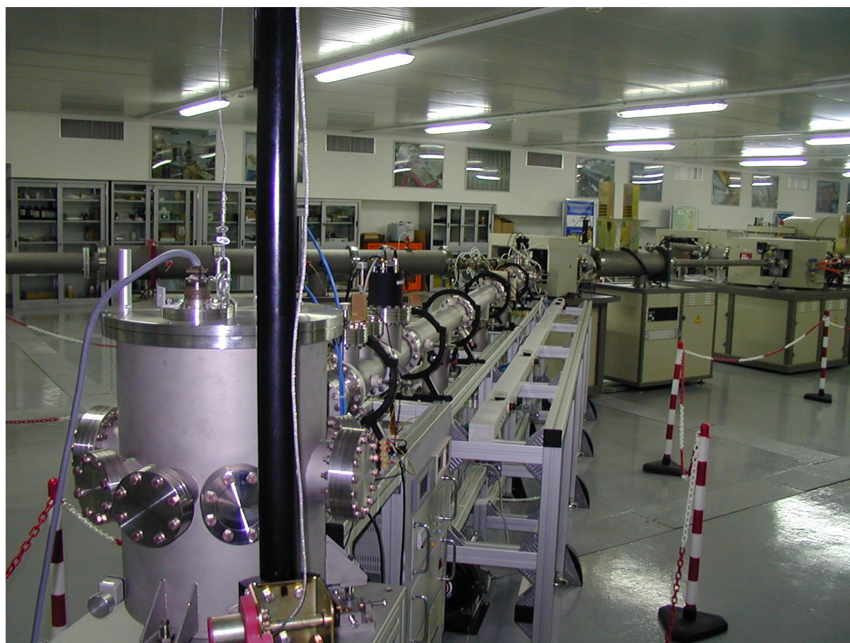
Figura 19: La linea sperimentale per analisi RBS-Channeling del CEDAD
