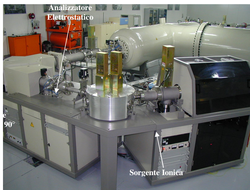
Figura 4: Lo spettrometro di bassa energia del sistema AMS in funzione presso il CEDAD
